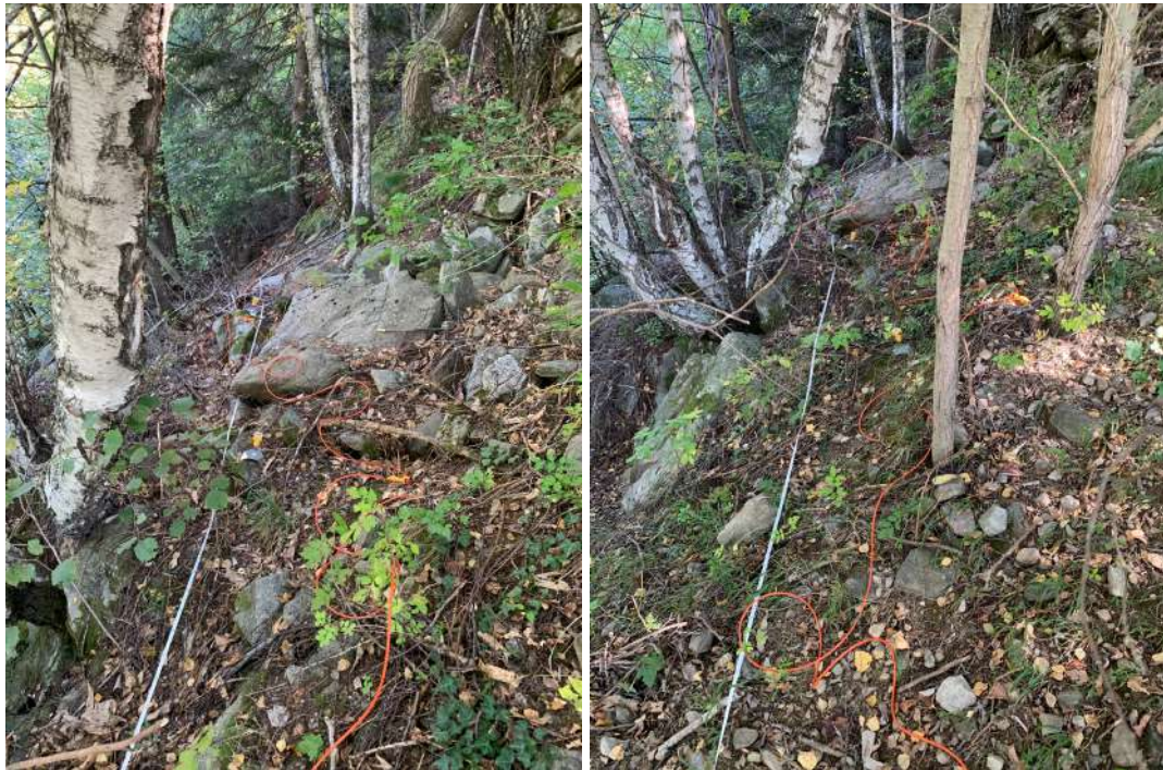
Stendimento sismico a rifrazione nei pressi del tornante della viabilità comunale di collegamento alla fraz. Farettaz
